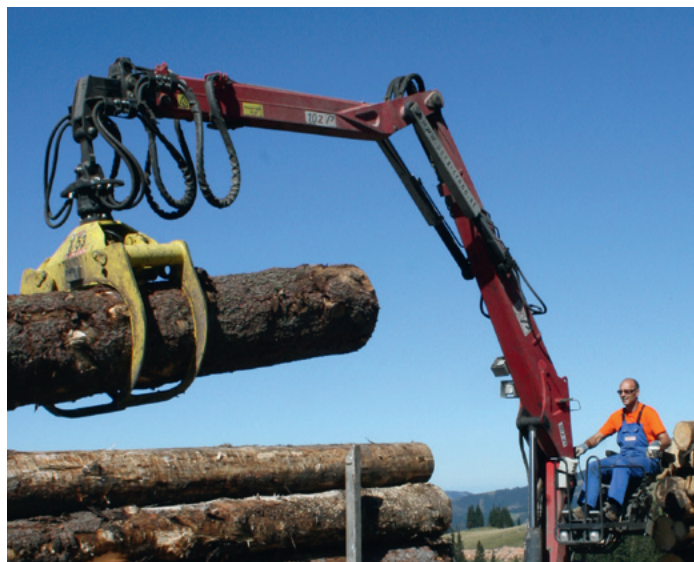
Der Penz 10Z mit 9,5 m Reichweite und 102 kNm Hubmoment erlaubt schnelle Hebe- und Schwenkbewegungen
