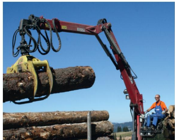
Der Penz 10Z mit 9,5 m Reichweite und 102 kNm Hubmoment erlaubt schnelle Hebe- und Schwenkbewegungen
